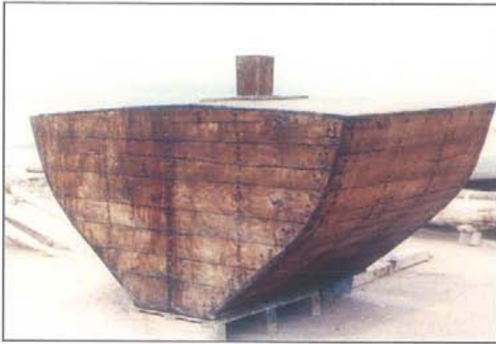
«الفتظاس» وهو خزان خشبي لحفظ الماء داخل السفينة الشراعية
