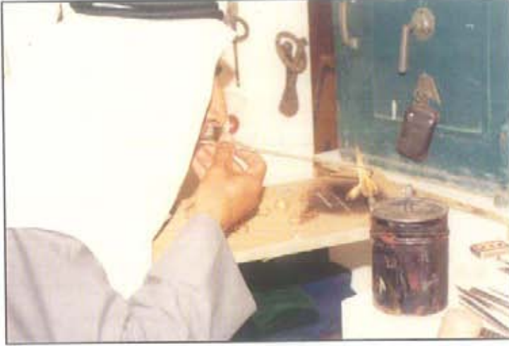
صايغ يقوم بلحميم قطعة صغيرة من الذهب مستخدماً «السراج» وهو ينفخ فيه بواسطة «البوري» لتوجيه النار ناحية القطعة .
