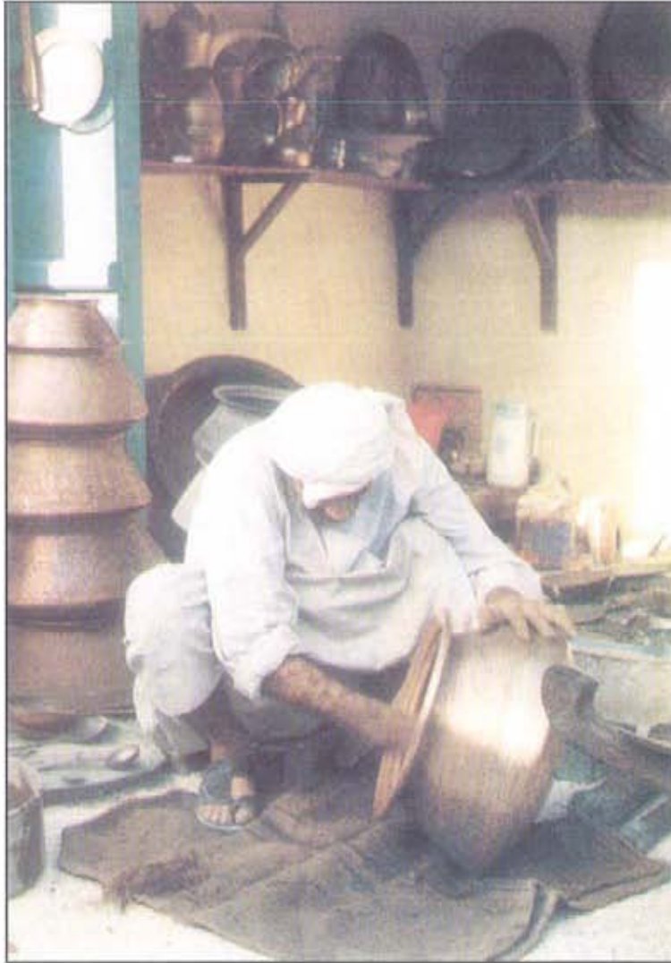
«تبييض» الأواني النحاسية من الأعمال التي يقوم بها الصفار مع بداية كل موسم
