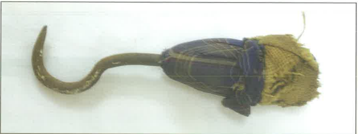
أداة تستخدم لرفع طرف كيس الأرز أو المواد الأخرى تمهيداً لحمل الكيس .
