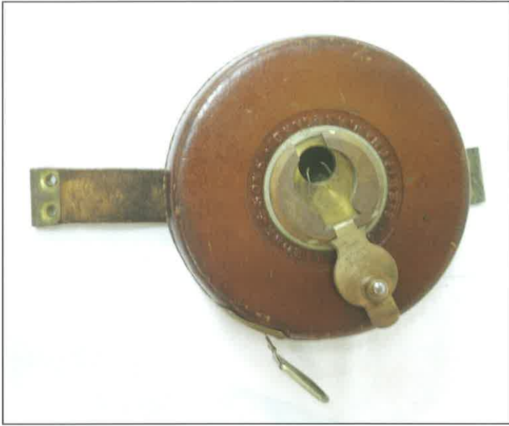
مقياس قديم للمسافات طوله ٥٠ متراً لقياس المسافات يستخدمها البنّاءون والتجارون .
