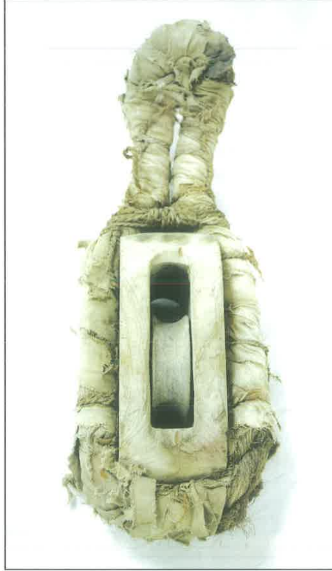
قفية (بكرة خشبية) لبيوار (حبل) دقل السفينة . والقفية عبارة عن محّاله تمر بها الحبال التي تسحب الشراع .
