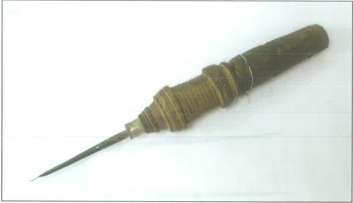
مجدح يستخدمه القلاف والنجار لثقب الخشب لتثبيت المسمار أو البرغي فيه . ويتم تدويره بجهاز يدعى ” القوس “ .
